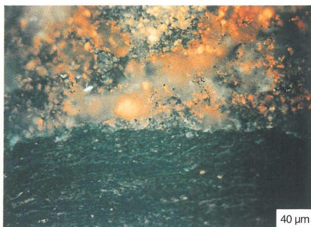
Ryc. 8. Wkładka wapienia impregnowanego epigenetycznymi bitumienami fluoryzującymi w barwach żółtopomarańczowych. Otw. wiern. Hel IG 1, gł. 3044,2 m. Światło odbite niebieskie, imersja olejowa Fig. 8. Thin limestone interbed impregnated with epigenetic bitumens showing yellow-orange fluorescence. The Hel IG 1 borehole, depth 3044.2 m. Reflected blue light, oil immersion
