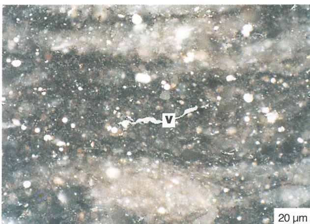
Ryc. 6. Soczewka wityrinitopodobna (v) ( R_o = 1,70\% ) w smużystych skupieniach materiału sapropelowego. Otw. wiern. Kościerzyna IG 1, gł. 4504,3 m. Światło odbite białe, imersja olejowa Fig. 6. Vitrinite — like lense (v) ( R_o = 1,70\% ) inside sapropelic flaser. The Kościerzyna IG 1 borehole, depth 4504.3 m. Reflected white light, oil immersion
