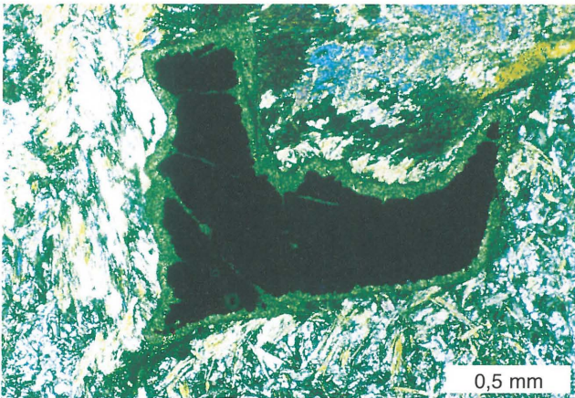
Ryc. 4. Mikrofotografia dużego kryształu ilmenitu otoczonego agregatem tytanitu. Skrzyżowane nikole
