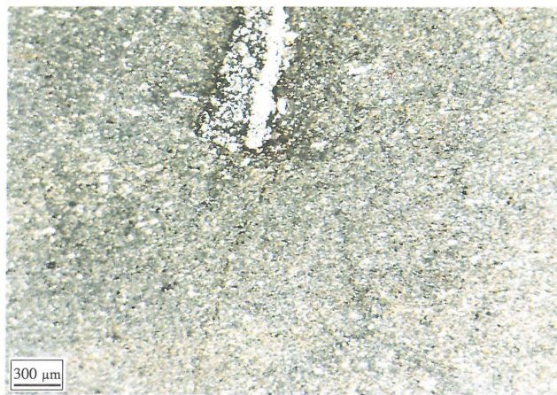
Ryc. 4. Droбноziarnisty tufit ze zblźnionym i skaolinizowanym fennokryształem skalenia, światło spolaryzowane, próbka SW-3
