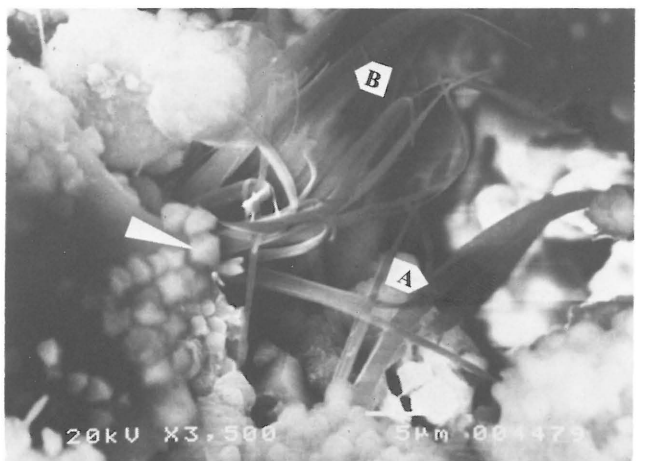
Ryc. 6. Wydłużone formy zeolitów. Zaznaczone punkty analiz EDS odpowiadają wynikom podanym w tab. 2 (A — LEG1Na-3-1; B — LEG1Na-3-2). Izometryczne kryształy (strzałka) nowopowstałych faz (zeolitów?). Elektrociepłownia w Łęgu. Próbką po traktowaniu roztworem NaOH
