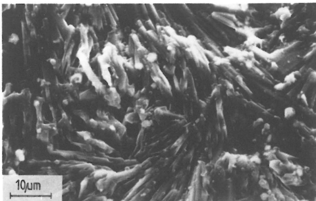
Ryc. 4. Słupkowe skupienia kryształów malachitu. Hyżne, stan. 1. Fig. 4. Scanning electron micrograph of prismatic crystals accumulations of malachite from Hyżne, site 1
