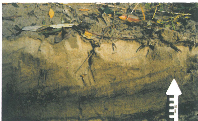
Ryc. 6. Wielozestaw warstwowanych przekątnie planarnie (w zestawach tangencjalnych), średnioziarnistych piasków nasypu za wałem przykorytowym
