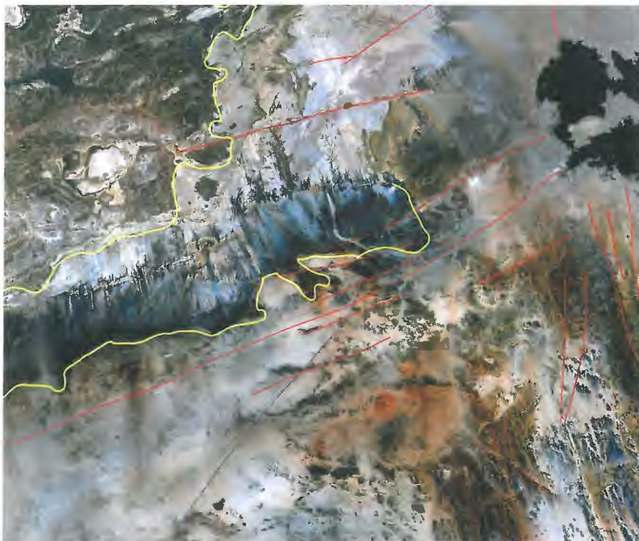
Ryc. 4. Wyniki wstępnej fotointerpretacji na tle kompozycji TM 321. Kolorem żółtym zaznaczono granice cofającej się skarpy Sinn El-Kaddab, a czerwonym uskoki należące do dwóch systemów — równoleżnikowego i południkowego
