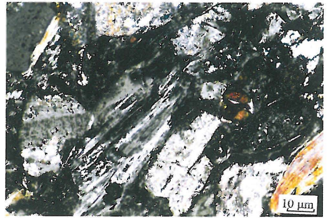
Ryc. 5. Ziarna skaleni potasowych i szkliwa pumeksowe w środkowej części tufitu. Tufit t-1. Polaroidy X Fig. 5. Grains of potassium feldspars and pumice glass in the middle part of tuffite. Tuffite t-1. Polarizers X
