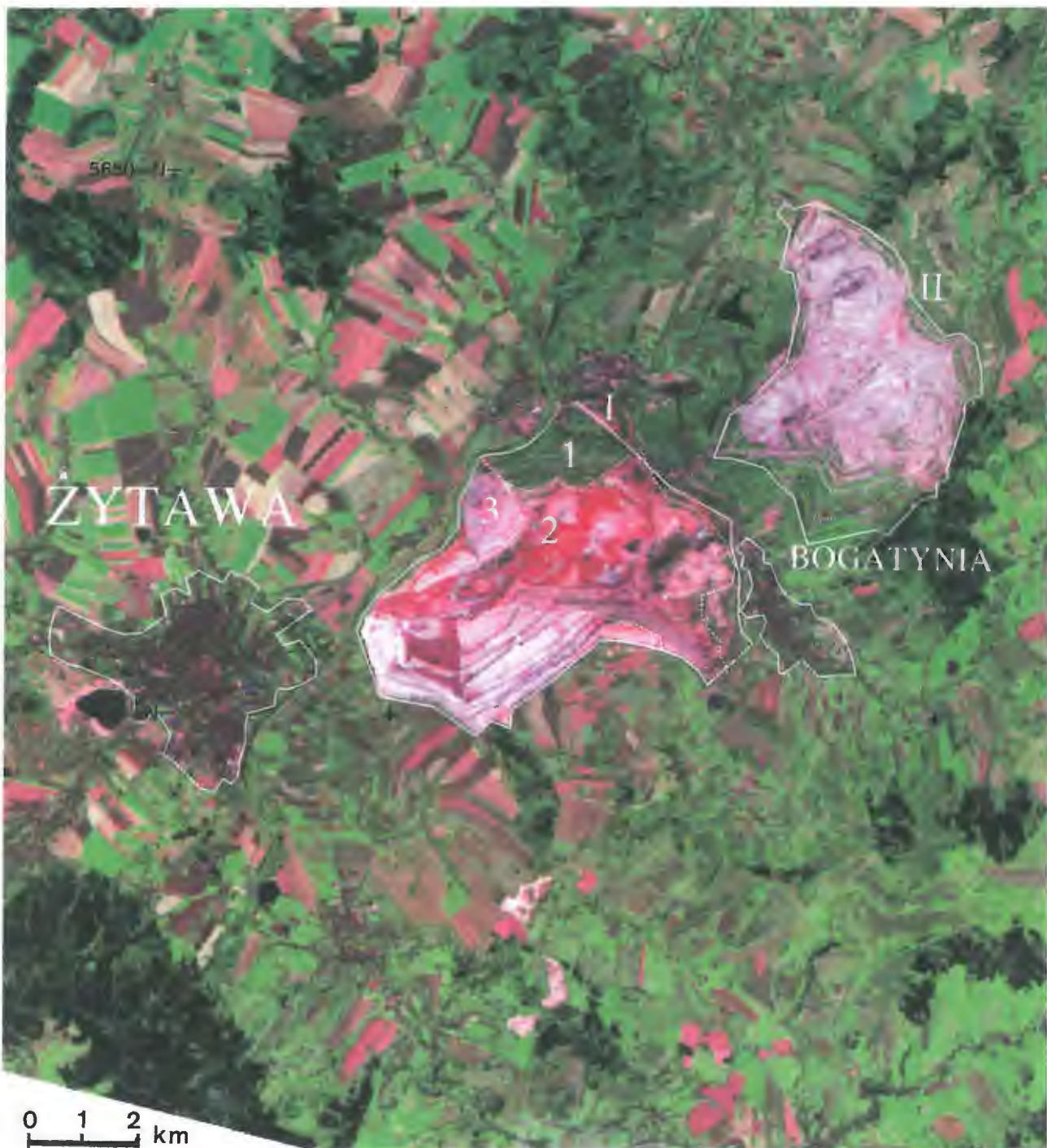
Ryc. 3. Rejon odkrywkowej kopalni węgla brunatnego Bogatynia–Zgorzelec. Zdjęcie satelitarne Landsat TM — jesień 1998 I — obszar odkrywki, II — hałda. 1, 2, 3 — zasięgi obszarów różniących się okresem eksploatacji (objaśnienia w tekście) Fig. 3. Satellite image (autumn 1998) of the open lignite mine in Bogatynia–Zgorzelec. I — open mine area, II — heap, 1, 2, 3 — extents of exploitation in different time
