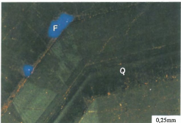
Ryc. 9. Kletno; CL; fragment kryształu kwarcu z widocznymi strukturami przyrostowymi podkreślonymi obecnością wrostków, m. in. fluorytu (F). Słabo widoczna budowa pasowa i sektorowa kwarcu (Q) w odcieniach brunatnych i zielonych. Fluoryt wykazuje ciemnoniebieską luminescencję
