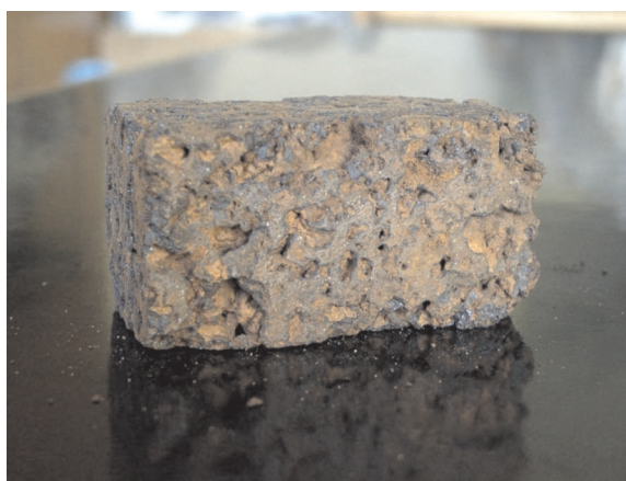
Ryc. 10. Prostopadłościenny blok wycięty z rudy darniowej. Widoczna znaczna porowatość Fig. 10. A rectangular block cut out of lump bog iron ore. Its significant porosity can be seen
