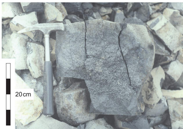
Ryc. 2. Bazalt zgorzelowy; „plamki” o rozmiarach rzędu 1 cm; kamieniołom Winna Góra k. Jawora
