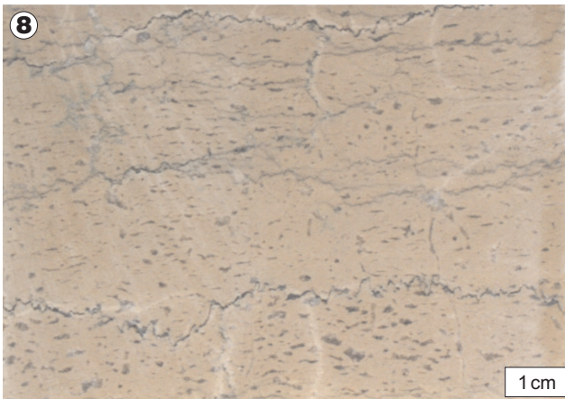
Ryc. 8. Wapienie z „ptasimi oczkami”. Zagorzycy-7, 2826,5 m, ogniwo wapienno-dolomityczne serii z Ropczyce. Zdjęcie rdzenia
