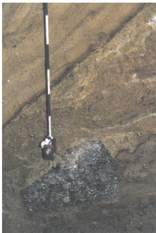
Ryc. 2. Fragment najwyraźniejszej powierzchni zniszczenia, oddzielającej warstwy A i B, widziany na ścianie bocznej wkopu. Sznurek wyznacza pion i pełni rolę podziałki — każdy jednobarwny fragment ma 5 cm długości
