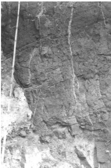
Ryc. 7. Pionowe spękania w glinie wypełnione martwicą wapienną
