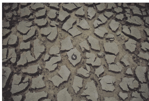
Ryc. 10. Szczeliny z wysychania na dnie stawu pokrytego matą zbudowaną z materiału, głównie mineralnego Fig. 10. Mud-cracks in the bottom of infiltration pond; the bottom is covered by mat consisting mostly of mineral material
