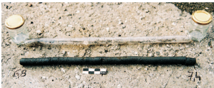
Ryc. 3. Fragment rdzenia z sondowania T4 (głęb. 6,8–7,4 m) w starej gazowni w Tomaszowie Maz. Przesycone smołą pogazową, tłuste, plastyczne, drobnoziarniste piaski dają się łatwo wysunąć z osłonki próbnika
