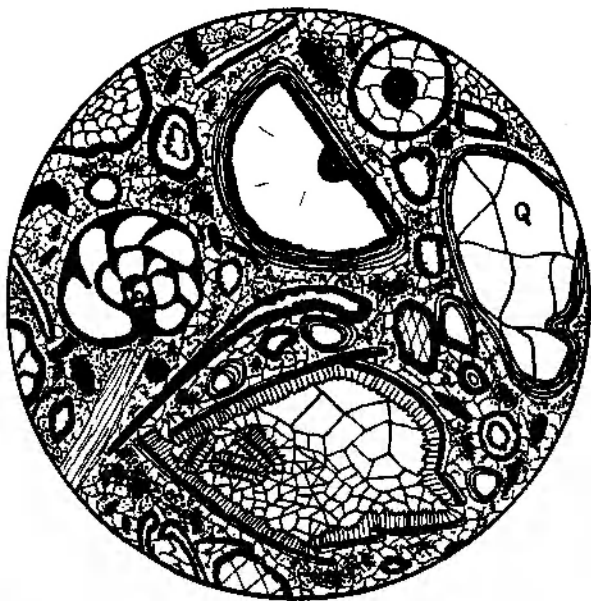
Fig. 2. Biosparyt z przejawami mikrytyzacji i wczesnodiagenetycznej cementacji (kamieniołom w Nowej Wsi, próba nr 32, nikole skrzyżowane, średnica obrazu: 2,5 mm). Q – ziarno polikrystalicznego kwarcu w drobnolaminowanej otoczce mikrytu
