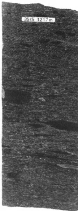
Fig. 19. Dość silnie zdeformowany wulkanoklastyk gruboziarnisty z dolnej części cyklu warstwowanego gradacyjnie. Spłaszczony klasty ciemnych skał wulkanicznych różnej wielkości. Otwór 35/S – 121,7 m
