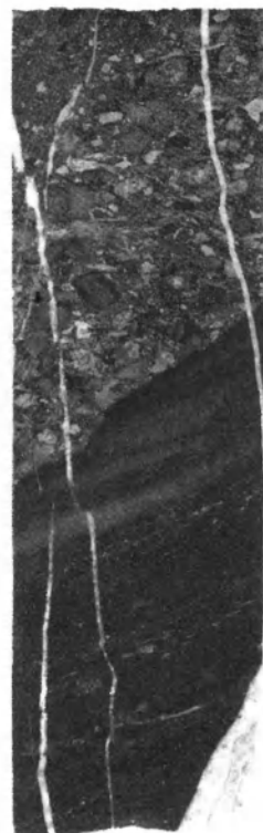
Fig. 21. Kontakt erozyjny wulkanoklastyku warstwowanego gradacyjnie (środkowa i górna część zdjęcia) z laminowanym mułowcem (u dołu). Otwór 38/S – 425,3 m
