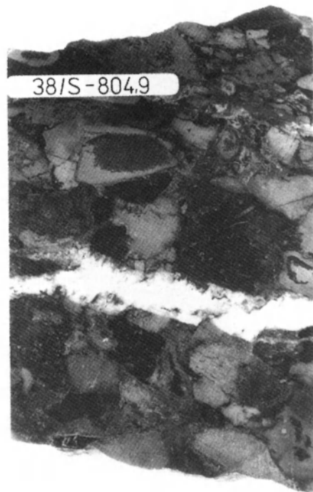
Fig. 18. Wulkanoklastyk gruboziarnisty z dolnej części cyklu warstwowanego gradacyjnie. Liczne słabo obtoczone klasty niezdeformowanych różnych skał wulkanicznych. Otwór 38/S - 804,9 m
