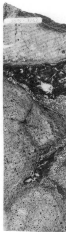
Fig. 15. Struktury reakcyjne na brzegu ciała magmowego – prawdopodobnie efekt reakcji gorącej magmy na nieskonsolidowany osad. Otwór 38/S – 324,2 m
