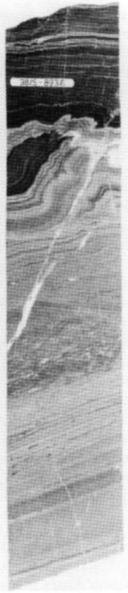
Fig. 22. Zaburzony kontakt wulkanoklastyków drobno- i bardzo drobnoziarnistych laminowanych (dolna i środkowa część zdjęcia) z ciemno-szarym laminowanym mułowcem (u góry). Otwór 38/S – 893,6 m
