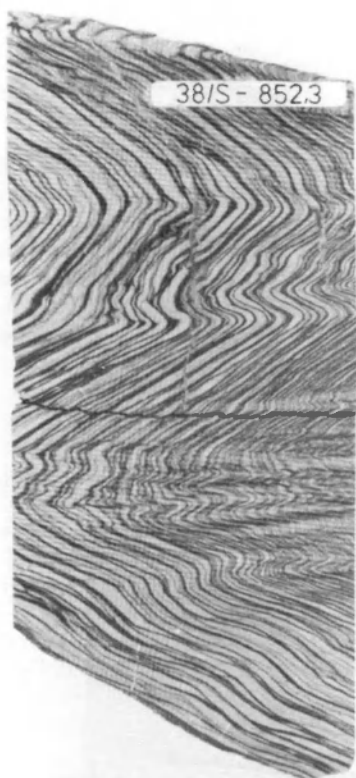
Fig. 10. Jasnoszary laminowany łupek pyłowo-ilasty; tektonicznie sfałdowana drobnosoczewkowa laminacja. Otwór 38/S - 852,3 m
