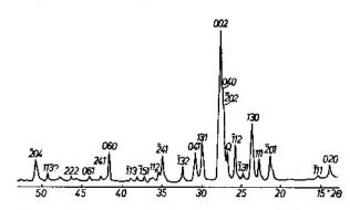
Fig. 4. Diffractogram of the Wielisławka sanidine  $(Cu_{K\alpha})$ . Q denotes the reflection caused by a quartz admixture Dyfraktogram sanidynu z Wielisławki  $(Cu_{K\alpha})$ . Q oznacza odbicie spowodowane domieszką kwarcu
