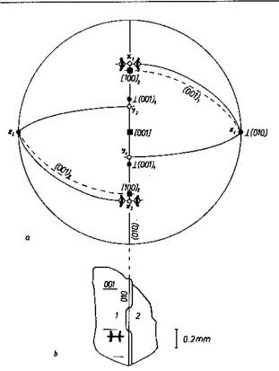
Fig. 3. Optic orientation of the sanidine Carlsbad twin in the stereographic projection (a) and its section drawn as seen in the microscope (b). The twin axis c = [001] is the projection axis Orientacja optyczna zbliźniaczeń karlsbadzkich sanidynu w projekcji stereograficznej (a) i przekrój przez nią naszkicowany tak, jak był widziany pod mikroskopem (b). Oś zbliźniaczenia c = [001] jest osią projekcji
