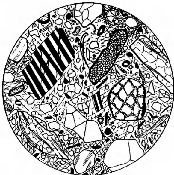
Fig. 9. Typ subszarogłazu wapnistego z Łącznej (szkic płytki cienkiej pod mikroskopem, szkielet ziarnowy luźny, tło skalne tworzy cement kalcytowy oraz najdrobniejsze frakcje składników detrytycznych)
