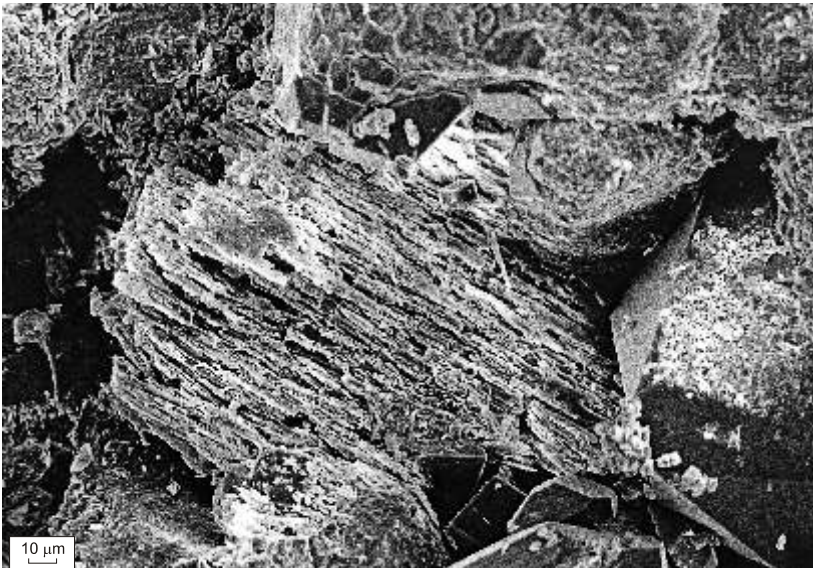
Fig. 14. Relikty skalenia potasowego pozostałe po jego rozpuszczeniu w arenicie kwarcowym
