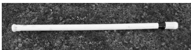
Fig. 4. Piezometr przed umieszczeniem go w odwiercie (z prawej strony widoczny filtr)
