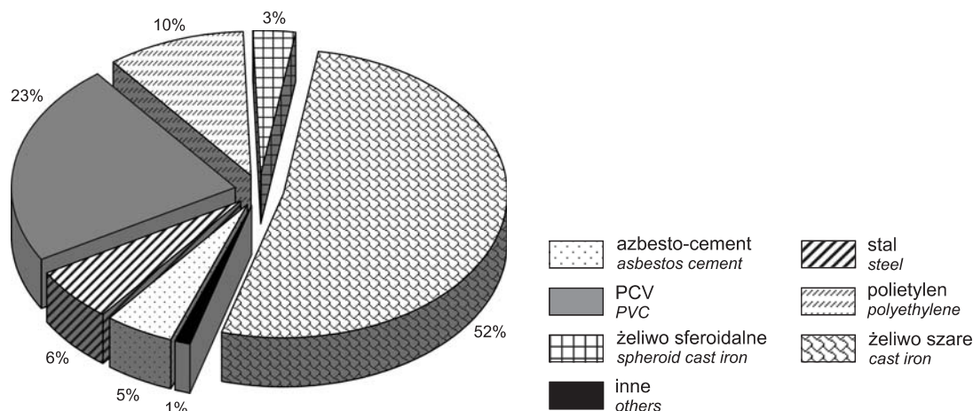
Fig. 3. Materiały stosowane w budowie sieci wodociągowej w Poznaniu (wg Aquanet S.A. w Poznaniu)
