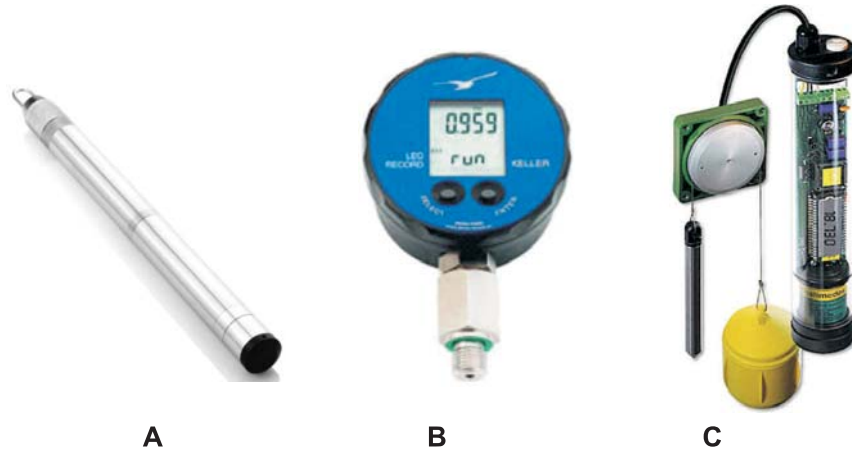
Fig. 2. Automacyjne przyrządy do pomiaru i rejestracji zmian poziomu i temperatury wód
