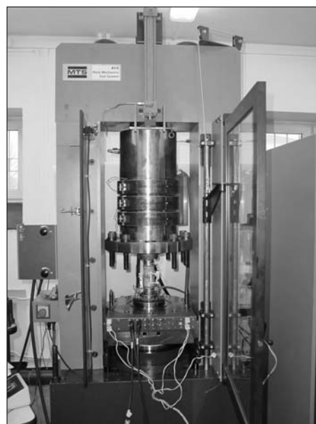
Fig. 1. Zestaw do badań wytrzymałościowych wyposażony w komorę termociśnieniową
