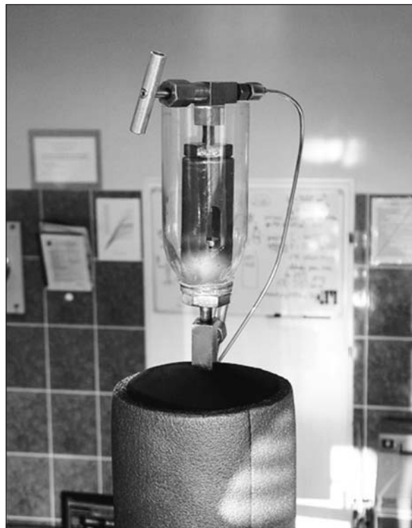
Fig. 8. Wziernik modelu złoża z osłoną bezpieczeństwa (Warnecki, 2011)
