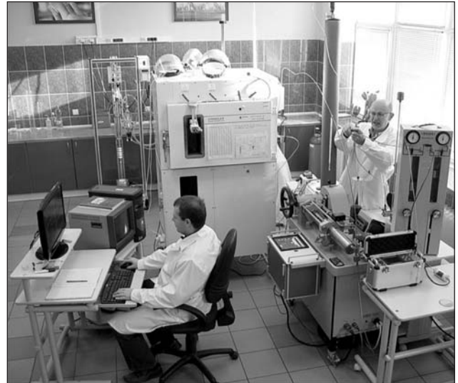
Fig. 6. Stanowisko badawcze do modelowania procesów wypierania (Warnecki, 2011)
