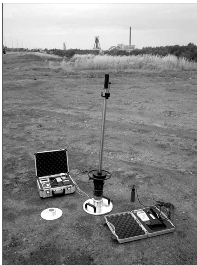
Fig. 6. Badanie nośności lekką płytą dynamiczną na składowisku LW Bogdanka (strefa S-3: odpady 8–10-letnie) (fot. M. Goździewicz, 15.09.2010 r.)
