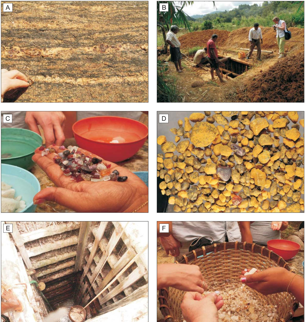
Fig. 4. A. Gnejs laminowany z licznymi granatami; Lwia Skała, Sigiriya (fot. K. Jarmolowicz-Szulc). B. Przykładowy szyb eksploatacyjny, Ratnapura (fot. Z. Szulc). C. Bogactwo kamieni szlachetnych i półszlachetnych z aluwiów Sri Lanki (fot. K. Jarmolowicz-Szulc). D. Próbkę przemytej skały okruczowej z Ratnapury pozyskana w wyniku płukania ilastej warstwy gemmonośnej; wyraźnie widoczne minerały – kamienie półszlachetne: ametysty (fioletowe otoczaki), granat (czerwony) i cytryn (żółty); wielkość ziarna granatu – 5 mm (fot. B. Ruszkiewicz). E. Szyb eksploatacyjny – wydobywanie kamieni księżycowych; Meetiyyagoda (fot. K. Jarmolowicz-Szulc). F. Minerały z przemytej próbki; Meetiyyagoda (fot. K. Jarmolowicz-Szulc)
