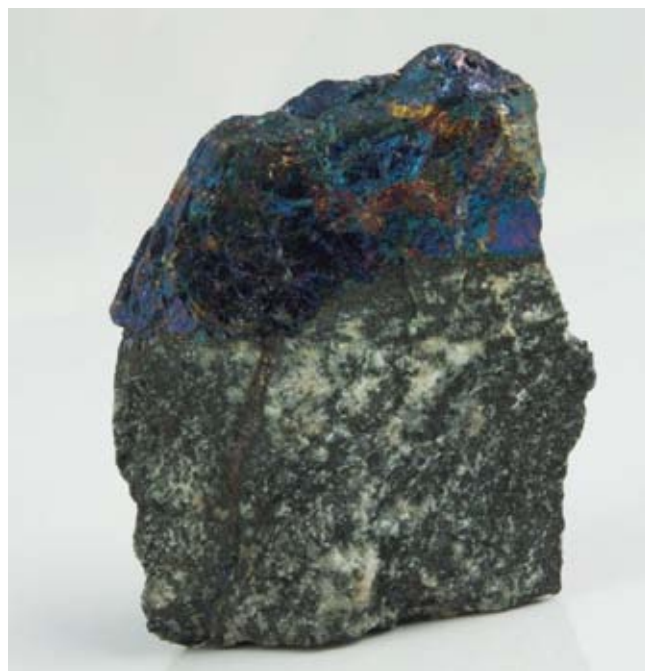
Fig. 9. Ostry kontakt bornitu ze zmienionym hydrotermalnie gnejsem. Rozmiar próbki 12 cm
