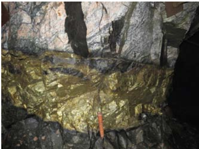
Fig. 5. Żyła chalkopirytowa w ścianie wyrobiska, z widoczną poniżej Brekcją Sudbury oraz gnejsami granodiorytowymi powyżej, złoże McCreey West
