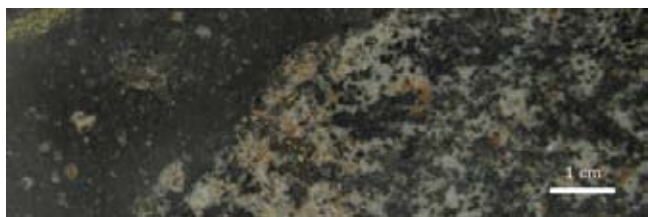
Fig. 3. Brekcja Sudbury (ciemnoszary, po lewej) oraz gnejs granodiorytowy należący do Kompleksu Gnejsów Levack (po prawej); zauważyć można rozproszony chalkopiryt
