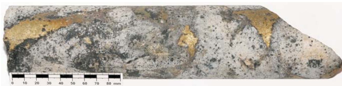
Fig. 17. Fragment rdzenia ze strefy hypogenicznej z bogatym okruszczeniem chalkopirytowym
