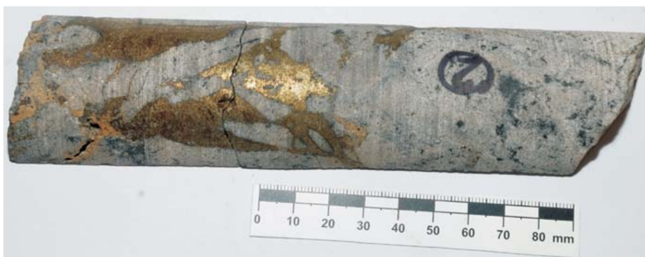
Fig. 18. Fragment rdzenia ze strefy hypogenicznej z bogatym okruszczeniem chalkopirytowym
