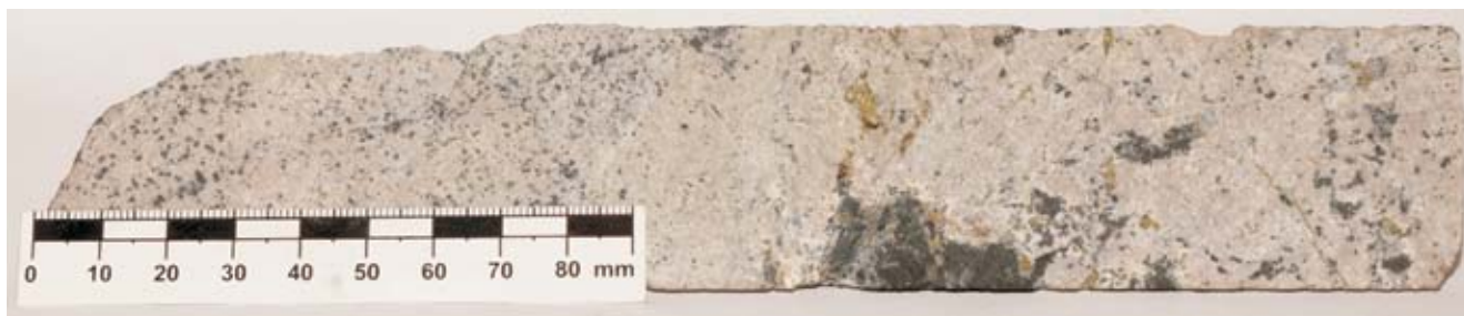
Fig. 19. Fragment rdzenia ze strefy hypogenicznej ubogim okruszczeniem chalkopirytowym
