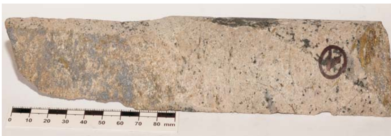
Fig. 20. Fragment rdzenia ze strefy hypogenicznej z bogatym okruszczeniem molibdenitowym, żółty – chalkopiryt
