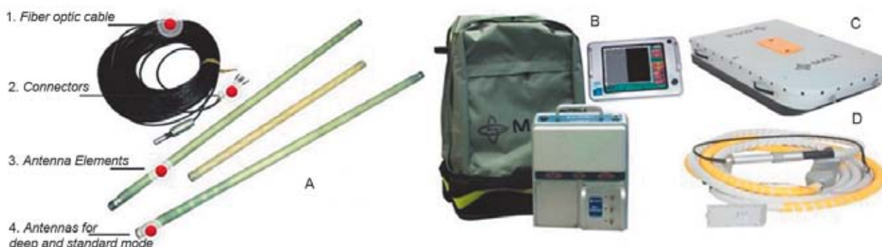
Fig. 8. A. Elementy zestawu 100MHz Slimhole Borehole Antenna producenta Malá Geoscience AB. B. Jednostka centralna georadaru ProEx wraz z monitorem XV. C. Antena ekranowana 100 MHz. D. Antena nieekranowana RTA 30 MHz. Materiały informacyjne firmy Malá
