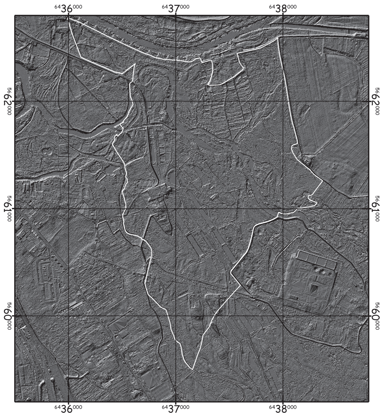
Fig. 3. Lidarowy, numeryczny model wysokościowy obszaru badań o rozdzielczości ok. 1 \times 1 m w projekcji PUWG92/19; fragmenty arkuszy M-33-35-C-a-4-3, M-33-35-C-a-4-4, M-33-35-C-c-2-1, M-33-35-C-c-2-2. Nałożona siatka współrzędnych PUWG2000/strefa6
