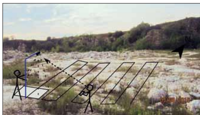
Fig. 9. Schemat ilustrujący sposób wykonywania dokumentacji fotograficznej podczas tworzenia ortofotomapy. Operator aparatu fotograficznego utrzymuje przyrząd rejestrujący równoległe do terenu, podczas gdy operator urządzenia mobilnego uruchamia migawkę aparatu za pomocą technologii Wi-Fi
