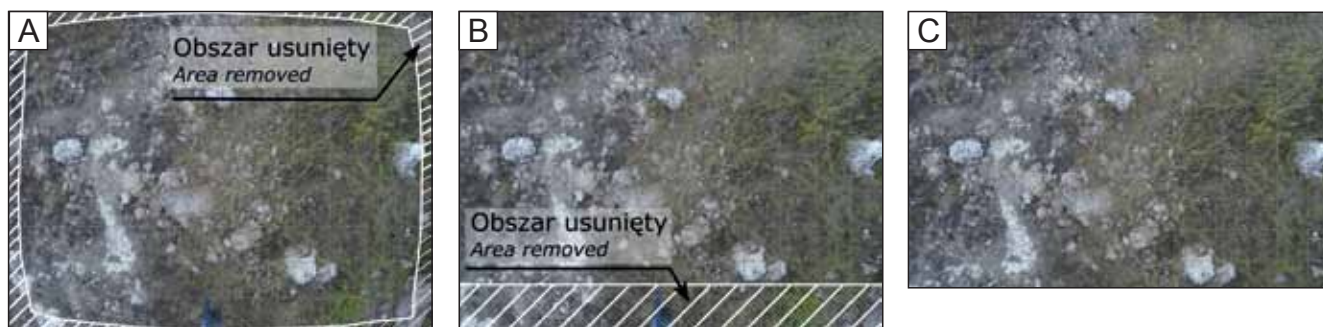
Fig. 11. Obróbka zdjęć fotograficznych, wykorzystywanych podczas tworzenia ortofotomapy kamieniołomu w Piskach
