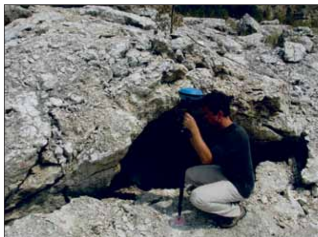
Fig. 6. Pomiary współrzędnych geodezyjnych GPS RTK, zdjęcie wykonane 6.08.2014 r.
