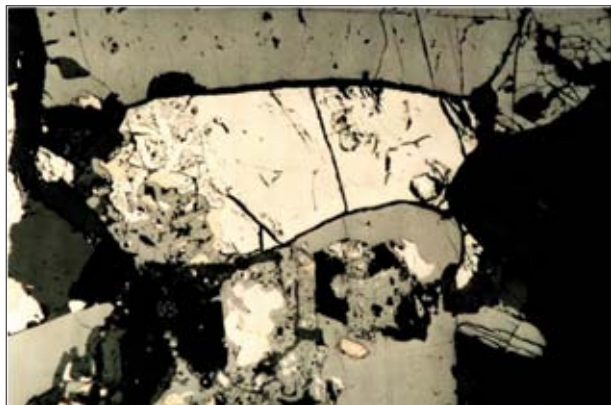
Fig. 10. Duże ziarno pirotytynu z odmieszaniem pentlandytu, chalkopiryty i bravoitu w otoczeniu tlenków Fe-Ti (światło odbite, pow. \times 10 )
