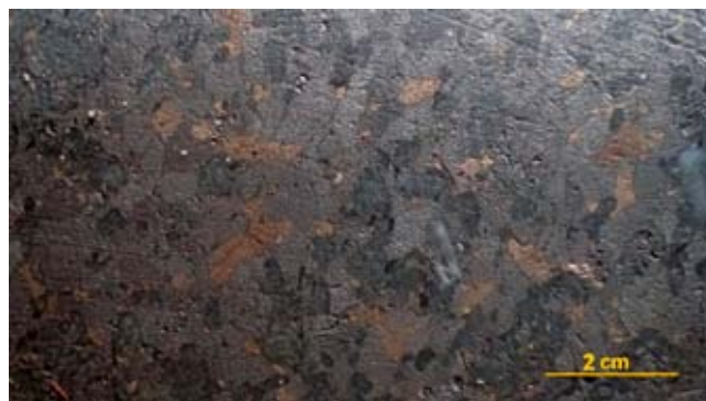
Fig. 4. Dystrybucja minerałów kruszcowych w poziomie rudonośnym Krzemianki
