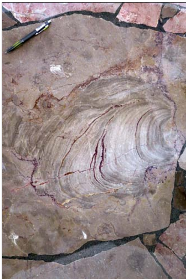
Fig. 4. „Marmur” z Bolechowic ze Stromatopora sp. z granicami między powłokami podkreślonymi hematytowymi inkrustacjami. Posadzka na korytarzu na pierwszym piętrze
