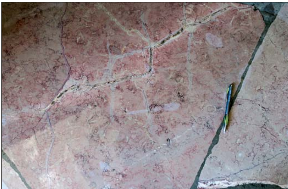
Fig. 6. „Marmur” z Szewce (obecnie nieeksploatowany), odmiana różowa z przypominającymi chmury strukturami bioturbacyjnymi oraz gałązkowymi Amphipora sp. Uwagę zwracają przecinające skalę różnej generacji żyły kalcytu. Posadzka na korytarzu na pierwszym piętrze
