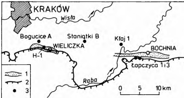
Fig. 1. Mapa osadów solonośnych w rejonie Wieliczka-Bochnia i rozmieszczenie omawianych wiercń. 1 — osady solne w jednostce nasuniętej; 2 — północny brzeg Karpat; 3 — otwory wiertnicze (z Garlickiego, 1975)
