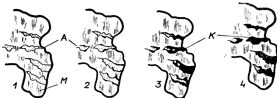
Fig. 7. Stadia powstawania kaolinitu ze skaleni, przekrój ac . 1 — pertyt mikroklinowy; 2 — tworzenie się lokalnie kaolinitu na granicy albitu z mikroklinem; 3 — dalej zaawansowany proces wypierania ze stadium poprzedniego (2); 4 — kaolinit w miejscu pertytowych przerostów z relikdami albitu; A — albit; K — kaolinit
