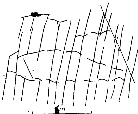
Fig. 31. Spękania w marglach, górna powierzchnia, Sidzina. Tylko jeden układ spękań poprzecznych rozwinięty
