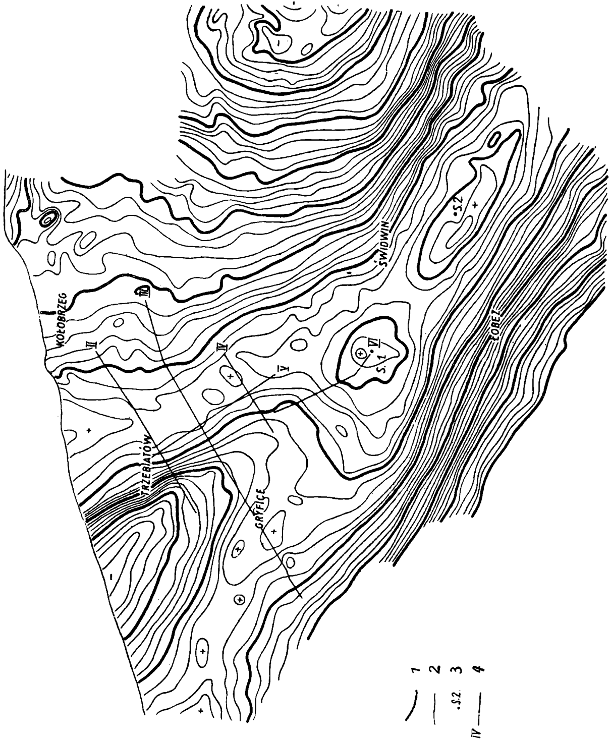
Fig. 3. Anomalie sily ciężkości w red. Bouguera w rejonie Świdwina — Trzebiatowa. Zdjęcie wykonane przez Przedsiębiorstwo Poszukiwań Geofizycznych w Warszawie. 1 — izolinie co 5 mGal; 2 — izolinie co 1 mGal; 3 — wiercenie; 4 — linie profilów
