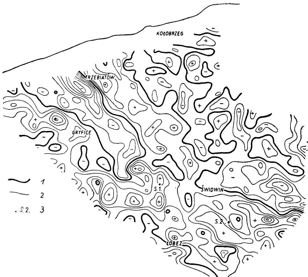
Fig. 6. Anomalie drugich pochodnych pionowych siły ciężkości w rejonie Świdwina — Trzebiatowa obliczone wzorem I T. Elkinsa, s = 2 km. 1 — izolinia zerowa, 2 — izoliny co 10 \cdot 10^{-15} cgs; 3 — wiercenia
