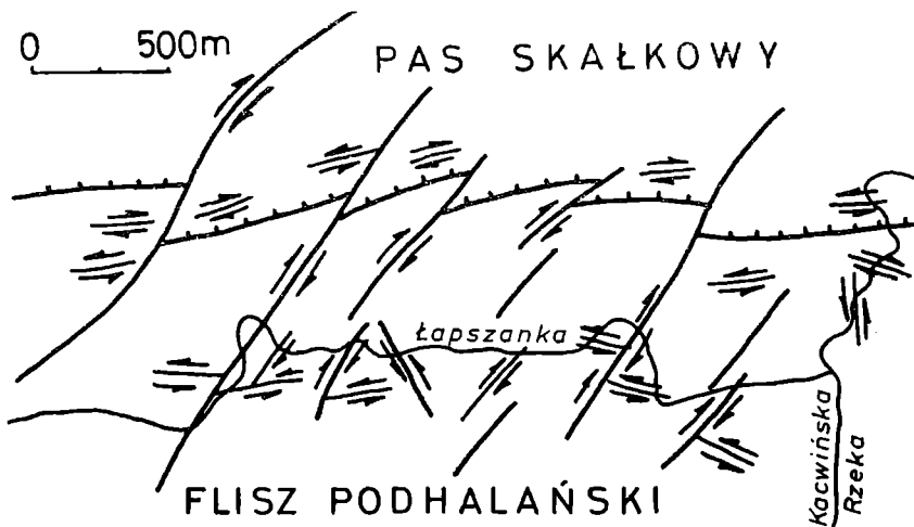
Fig. 8. Szkic rozmieszczenia uskoków przesuwczych w strefie kontaktu fliszu podhalańskiego z pienińskim pasem skałkowym. Wschodnia część badanego obszaru Fig. 8. Sketch-map showing the distribution of the wrench faults in the contact zone. Eastern part of the area
