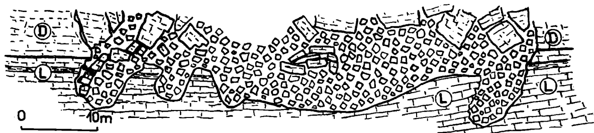
Fig. 2. Wykształcenie spągowej części jamy krasowej wypełnionej brekcją: L — wapień gogoliński; D — dolomity kruszczośne
