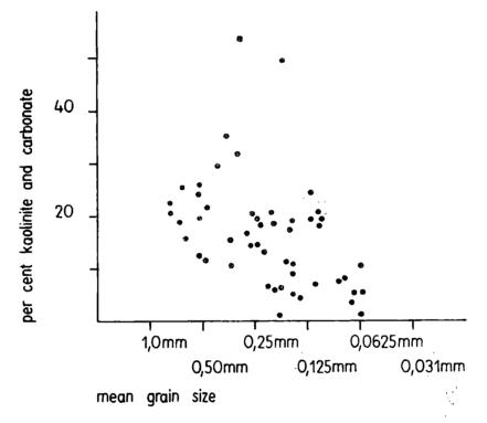
Fig. 2. Showing content of kaolinite and carbonate versus grain size (microscopic data) Fig. 2. Wykres ilustrujący zawartość kaolinitu i węglanów w zależności od rozmiarów ziarna (dane mikroskopowe)
