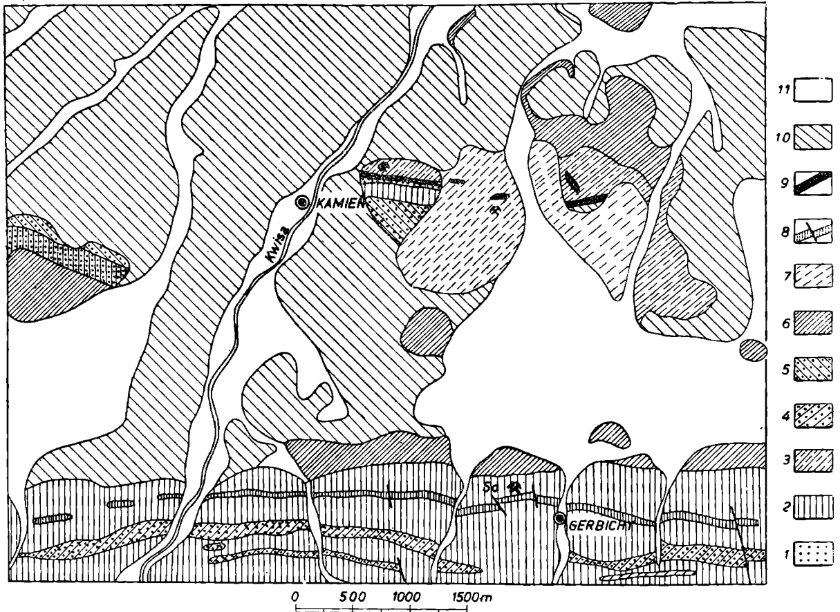
Fig. 1. Mapa geologiczna okolic Kamienia (Dolny Śląsk) wg M. Budkiewicza (1949) na podstawie mapy geologicznej Berga i Ahrensa (1926): 1 — ortoamfibolit; 2 — łupek mikowy; 3 — gnejs pegmatytowy; 4 — gnejs drobnoziarnisty; 5 — gnejs ziarnisty; 6 — gnejs wstęgowy; 7 — gnejs skaolinizowany; 8 — łupek chlorytowy; 9 — żyła kwarcowo-topazowa; 10 — plejstocen; 11 — holocen
