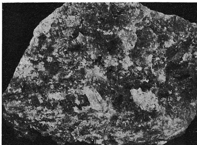
Fig. 1 Tekstura sylwinitu w próbie pochodzącej z chodnika 540 na poziomie VI — Inowrocław Szerokość próby 31 cm u podstawy
