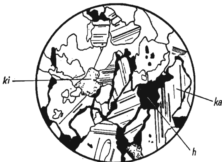
Fig. 8 Budowa karnalitu różowego, drobnoziarnistego. — Wapno ka karnalit; ki kizeryt; h halit X 30
